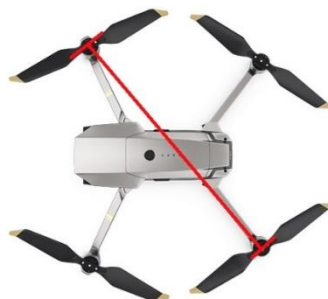
Рис 4. Схематичное изображение расстояния между двигателями (роторами)
